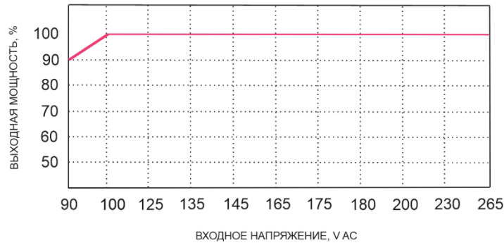
Зависимость выходной мощности от изменения входного напряжения
